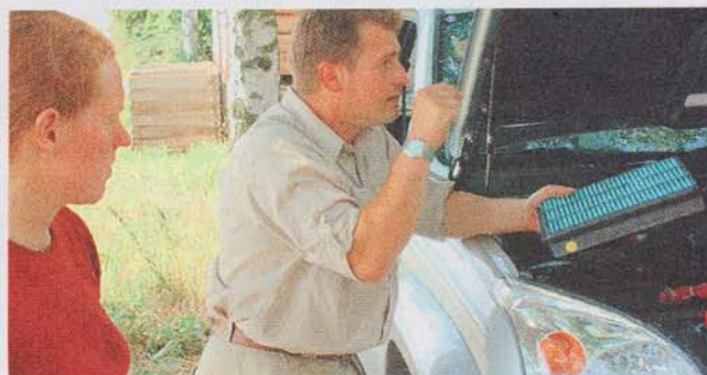
Beispiel Luftfilter: Bei Bedarf (z. B. starke Rauchentwicklung, wenig Leistung) mit Luftdruck stets von der sauberen Seite her ausblasen.
