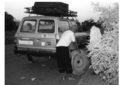
Reifen können auch mit Sekundenkleber und Araldit repariert werden. Improvisationen helfen über viele Pannen hinweg. Wichtig ist, das Richtige dabei zu haben.
